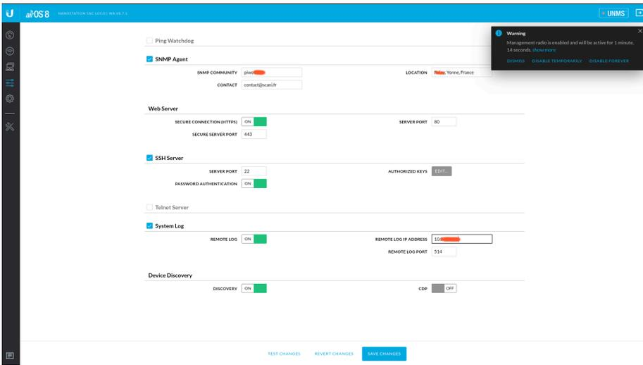
Nous continuons la configuration en configurant le SNMP et notre System Log en mettant notre IP.
